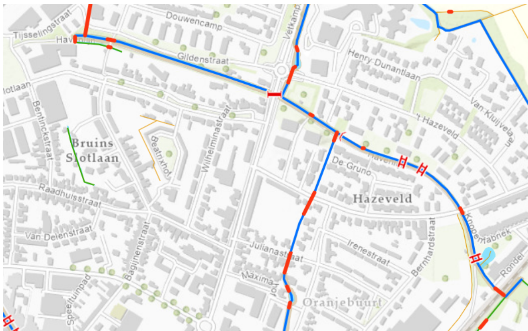
Figuur 1: Overzicht van de onderhoudsstrook van het waterschap langs de Havenlijn (blauw) en de duikers/bruggen in de watergang (rood).
